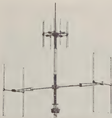
ASDF antenna. (AEG)
